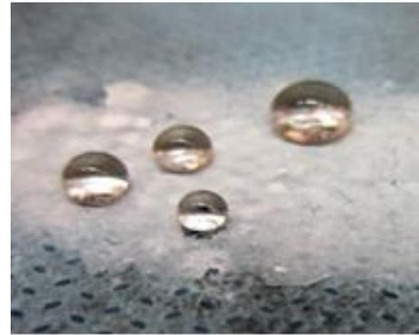
Рисунок 4.14 - Капли воды на поверхности нановолокнистого материала
